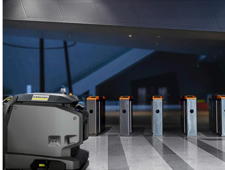
WLAN-Zugriff. Das integrierte 4G LTE Modul kommuniziert mit dem Anwender über das KIRA Webportal und sendet Fehlermeldungen direkt per Push. Sollte die Reinigungskraft keinen Zugriff auf das Portal haben, kann Sie durch den Objekt-Beauftragten als Kontaktperson für mobile Benachrichtigungen eingerichtet werden und auf die Meldung reagieren. So werden mögliche Ausfall- und Wartezeiten auf ein Minimum verkürzt.
